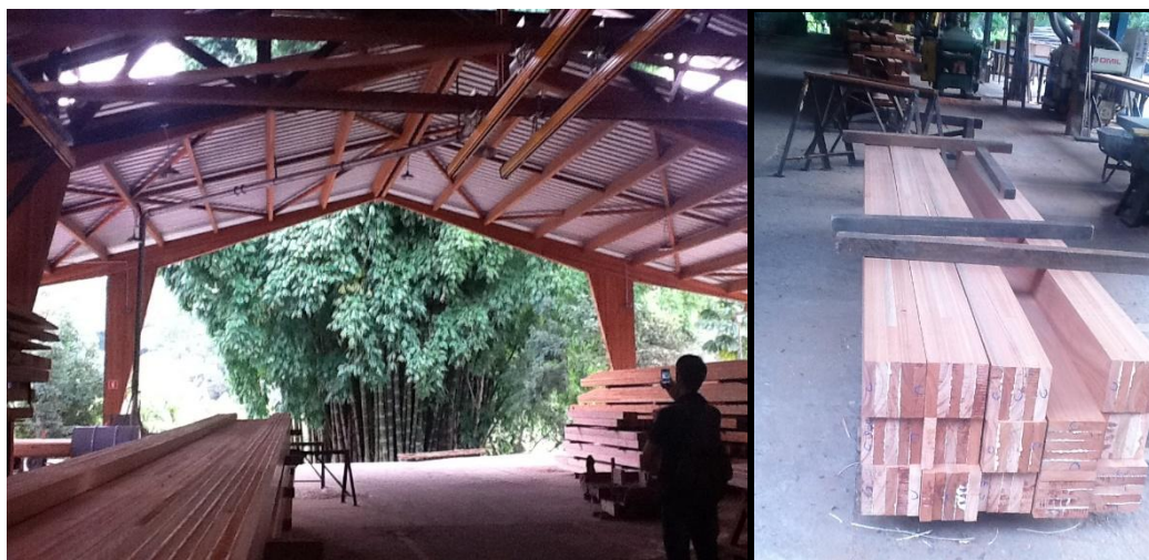
Figura 2 A: indústria de madeira laminada ITA Construtora. 2 B: vigas de madeira laminada
